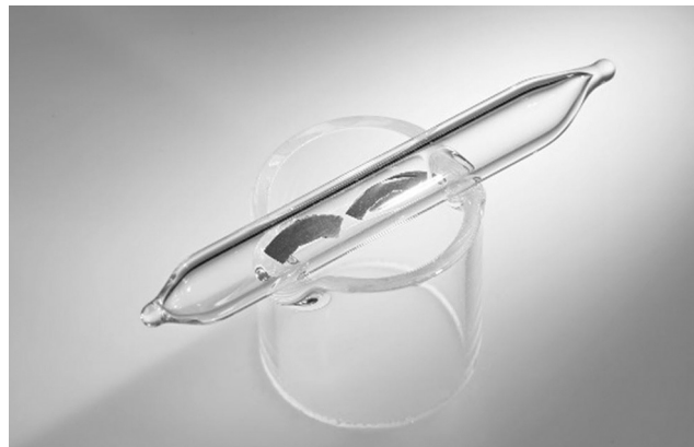
Abbildung 1. Eine Probe reinen Be-Metalls in einer unter Ar abgeschmolzenen Glasampulle. Bild: A. Heddergott.
